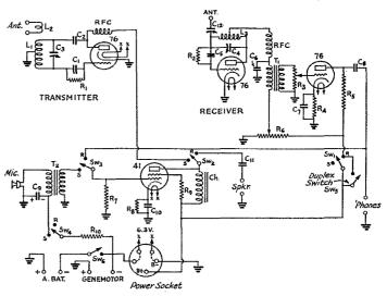
FIG. 1—CIRCUIT OF THE 56-MC. TRANSMITTER-RECEIVER
