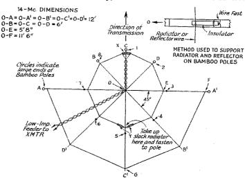
FIG. 1—SCHEMATIC PLAN OF THE ANTENNA AND REFLECTOR ASSEMBLY FOR 14-MC. OPERA-TION
