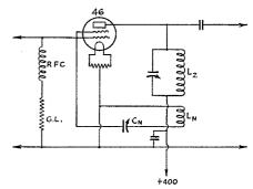
FIG. 5—ADDING REGENERATION (NEUTRALIZA-TION) TO A DOUBLER STAGE
